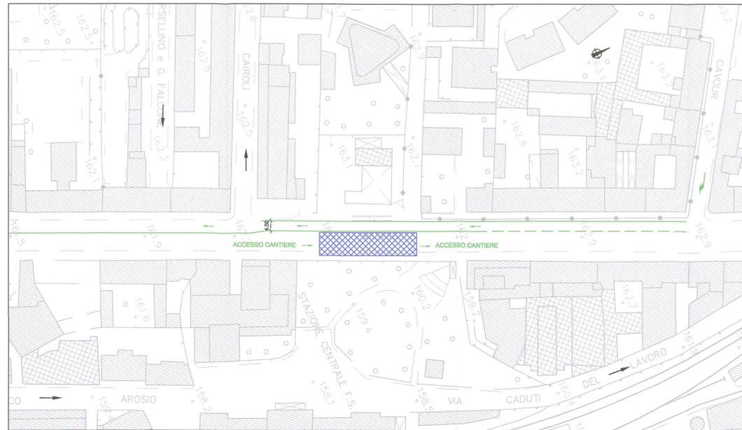
FASE 2: costituzione sul lato est di corso Milano di 2 corsie, una per senso di marcia, al di sopra della parte di copertura di stazione eseguita in fase 1. Completamento della costruzione delle paratie perimetrali e della copertura del corpo stazione
